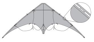
Edge Rod over the Internal Ferrule of the Upper Leading Edge Strut.
